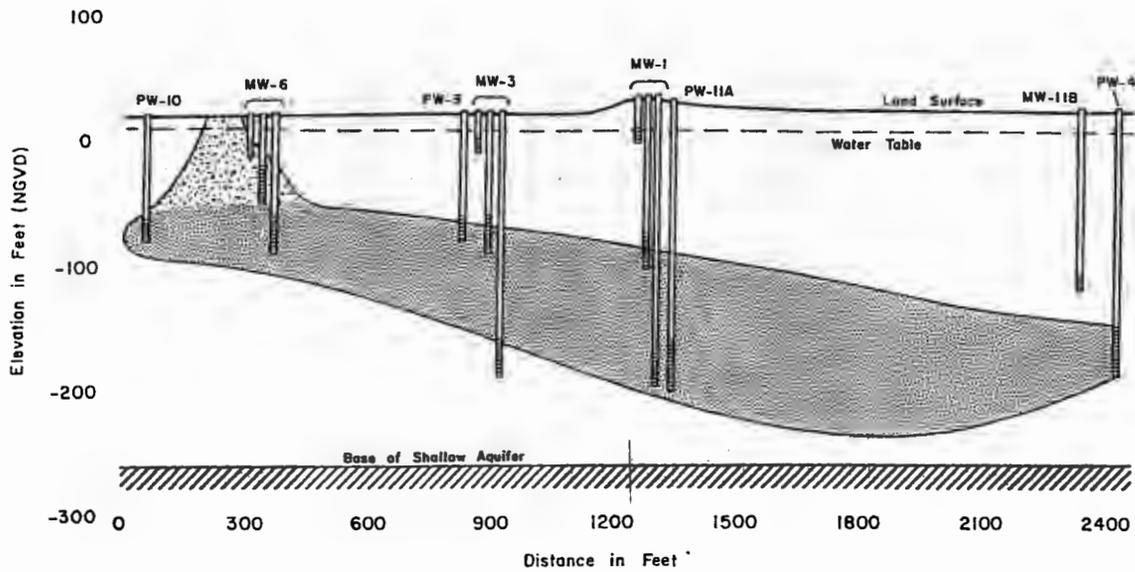
Figure 43. VERTICAL DISTRIBUTION OF SOLITRON PLUME
