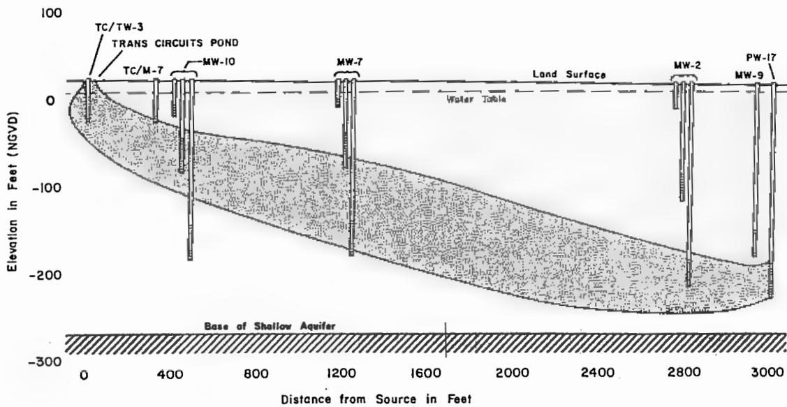
Figure 39. VERTICAL DISTRIBUTION OF PW-17 CONTAMINATION PLUME
